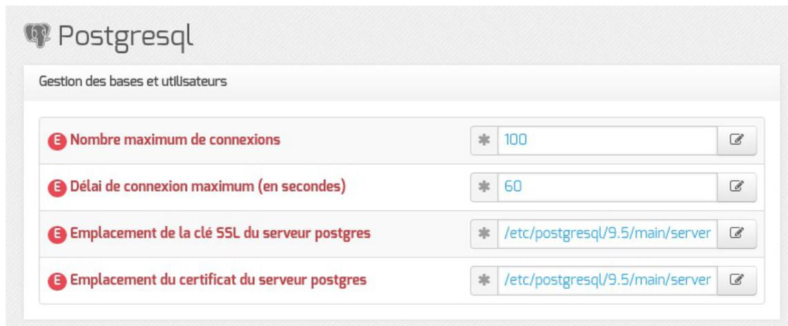
Vue de l'onglet Postgresql de l'interface de configuration du module
