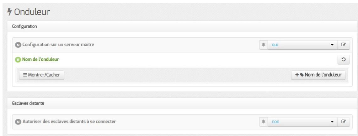
Si l'onduleur est branché directement sur le module il faut laisser la variable Configuration sur un serveur maître à oui, cliquer sur le bouton + Nom de l'onduleur et effectuer la configuration liée au serveur maître.
