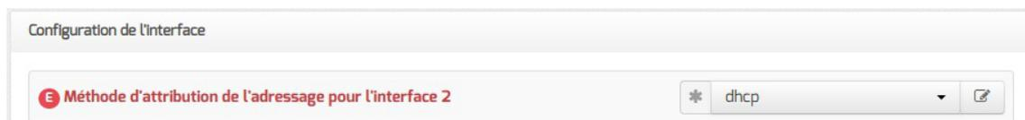
En mode expert, il est possible de configurer l'interface en mode DHCP<sup>[p.486]</sup>.
