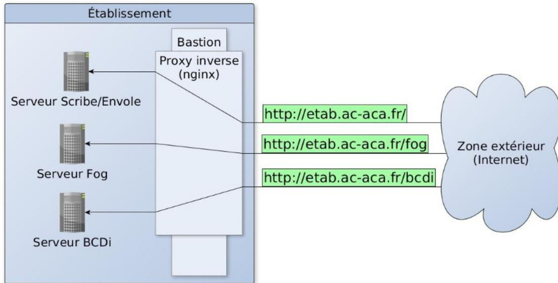
Avant toute chose, le proxy inverse doit être activé dans l'onglet **Services** en passant Activer le reverse proxy Nginx à oui.
