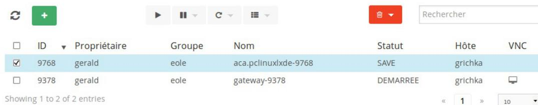
Pour remettre en route une machine suspendue il faut la sélectionner dans la liste et cliquer sur le bouton **Lecture**. La ou les machines sélectionnées repassent en statut **DEMARREE**.
