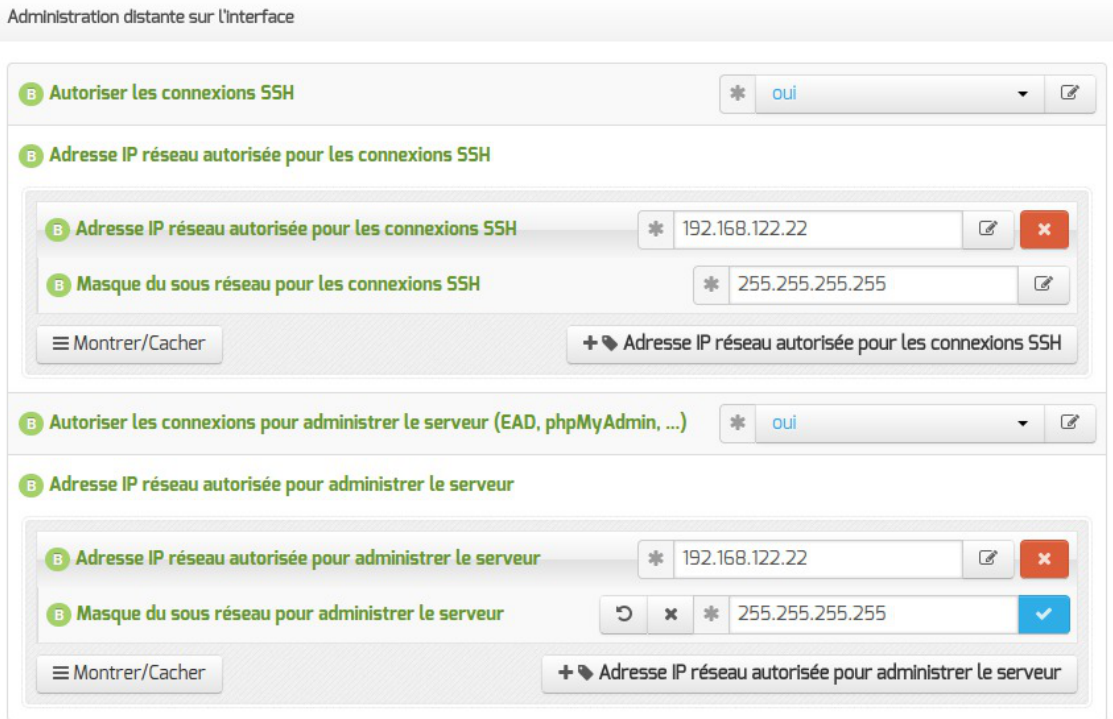
Configuration de l'administration à distance sur une interface
