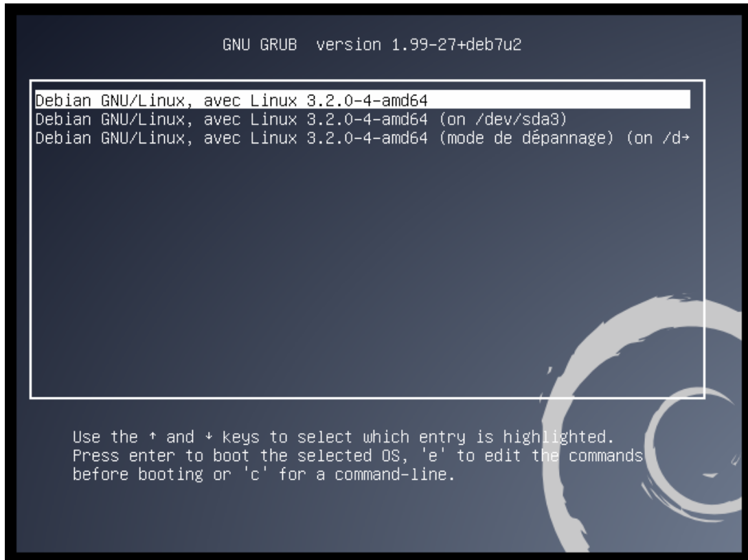
FIGURE 6.75 – Nous nous retrouvons face au menu du GRUB. Nous choisissons maintenant de démarrer le système principal.
